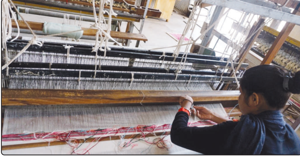
चित्र-3 : हथकरघे पर डिजाइन अंगोरा शॉल का निर्माण एवं उनका तकनीकी विवरण
